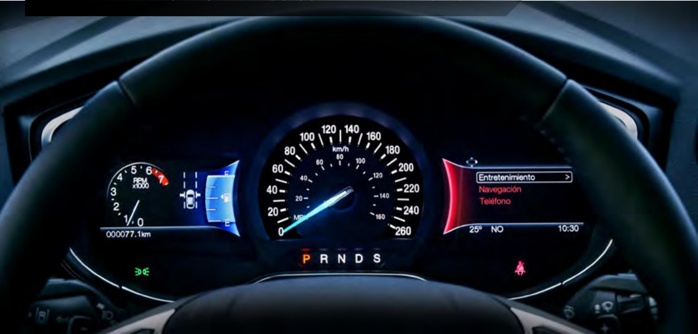
*La pantalla izquierda muestra información acerca del estado del vehículo, los sistemas de seguridad y la economía de combustible, mientras que la derecha permite visualizar información relacionada con el sistema de conectividad SYNC® 3.*
