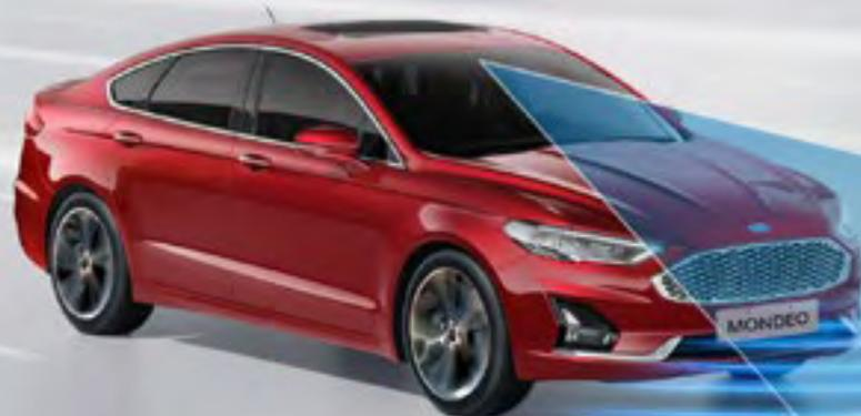
*Regula automáticamente la velocidad tomando como referencia la distancia con el vehículo de adelante. Dicha distancia es regulable por el conductor. Si el vehículo de adelante se detiene (en un semáforo, por ejemplo), el auto con el crucero adaptativo se detendrá también y volverá a avanzar cuando dicho vehículo avance nuevamente.*
